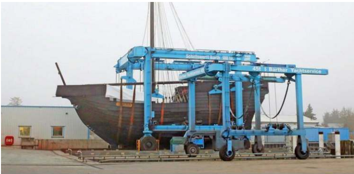
Die Pommerkogge „Ucra“ wird in Barth zu Wasser gelassen. Der Travellift der Werft kann bis zu 180 Tonnen bewältigen.
