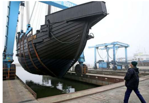
Werftmitarbeiter Edwin Reske senkt die laut Display 147,5 Tonnen schwere Kogge in den Slipgraben hinab: „Es war das schwerste Holzschiff, dass ich jemals in den Gurten hatte.“
