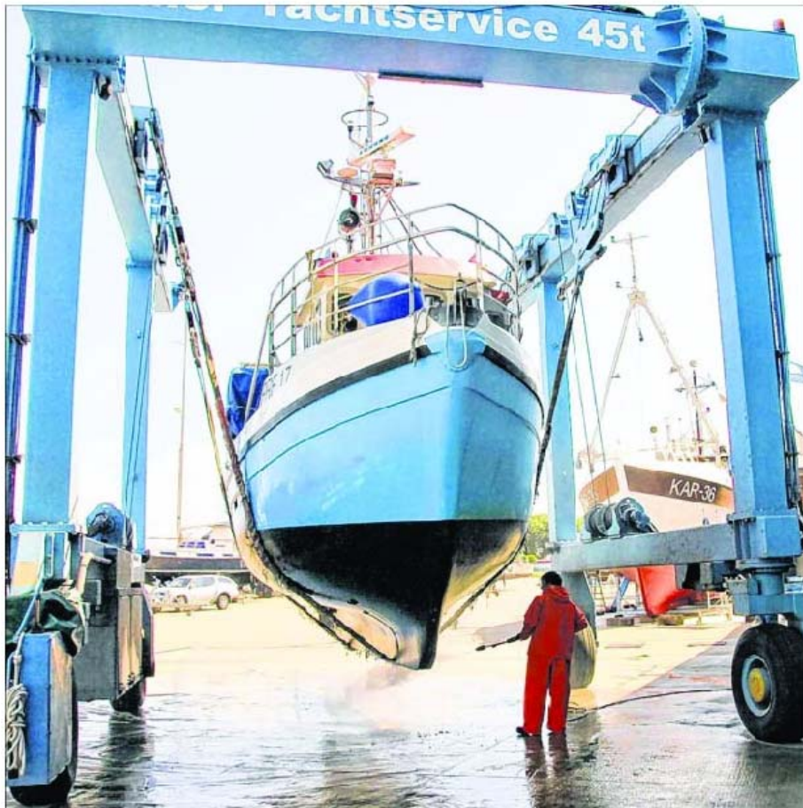
Mit einer Hochdrucksprühlanze wird der Rumpf des Fischkutters gereinigt.
